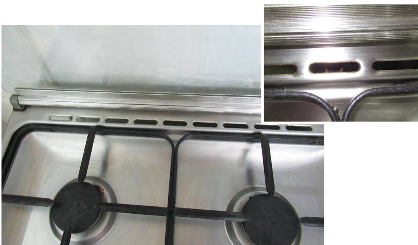
37. תנור אפיה בו פתחי יציאת אדי הארובות ממוקמים בקצה משטח הכירה, אדים חמים העולים מאפייט מין אחד עלולים לפגוע בסיר מהמין השני העומד על הכירה. מימין: פתחי הארובה בהגדלה.
